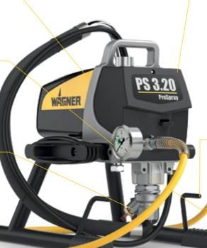
**Schlauchaufwicklung:** für die optimale Aufbewahrung des Schlauchs
